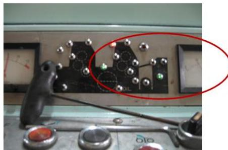
■ **Gambar 3.** Lampu Indikator Kerusakan pada Mesin *OLIVER* Tipe 258E
