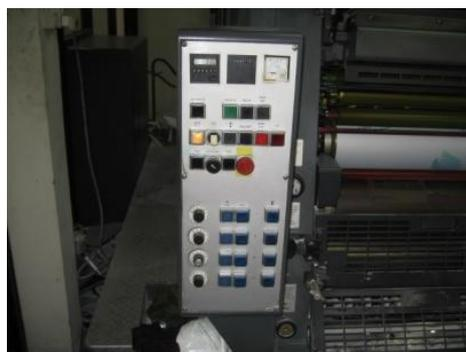
■ **Gambar 5.** Lampu Indikator dan *Counter* Mesin Cetak di Percetakan Q-MAX
