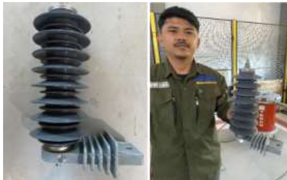
Gambar 2. Lightning Arrester Berbahan Polimer
