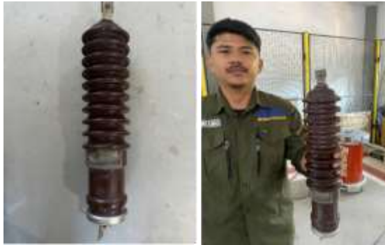
Gambar 1. Lightning Arrester Berbahan Keramik
