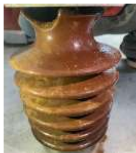
Gambar 8. Kondisi Isolator terpolusi basah
