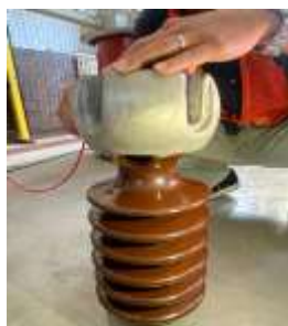
Gambar 5. Kondisi Isolator Bersih Kering
