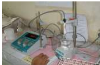
Gambar 4. Penentuan Konduktifitas Fly Ash menggunakan Konduktometer
