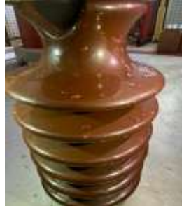
Gambar 6. Kondisi Isolator Bersih Basah
