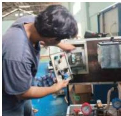
Gambar 3. Proses Perakitan Kotak Panel
