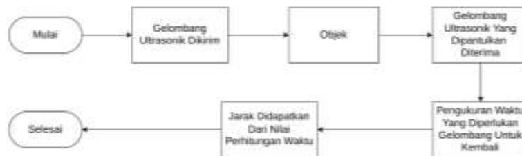
Gambar 4. Flowchart Pembacaan Sensor Ultrasonik
