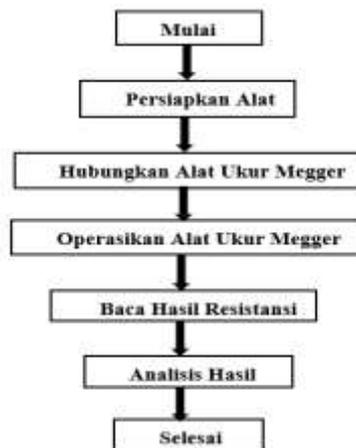
Gambar 5. Flowchart Tahapan Pengukuran
