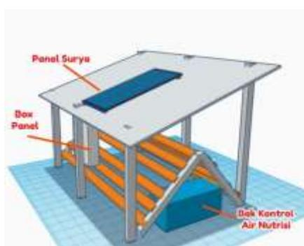
Gambar 4. Visualisasi Penempatan Alat
