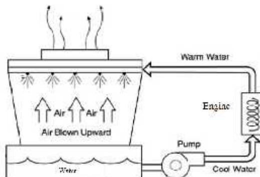
Gambar 1 Proses Kerja Pembuangan Panas Pada *Cooling Tower* [2]
