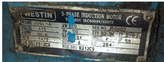
Gambar 12. Spesifikasi untuk motor listrik pada mesin *press* (Dokumen Pribadi)
