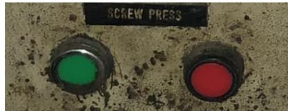
Gambar 10. *ON & OFF Button* pada panel *press* (Dokumen Pribadi)
