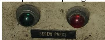
Gambar 11. Lampu Indikator pada panel *press* (Dokumen Pribadi)
