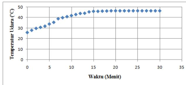
■ Gambar 10. Grafik Hasil Pengujian Modul Pemanas Udara
