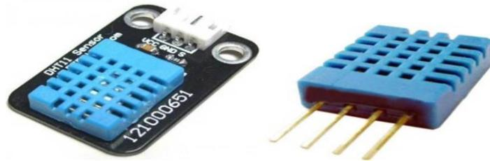
■ Gambar 1. Sensor Suhu dan kelembapan DHT11
