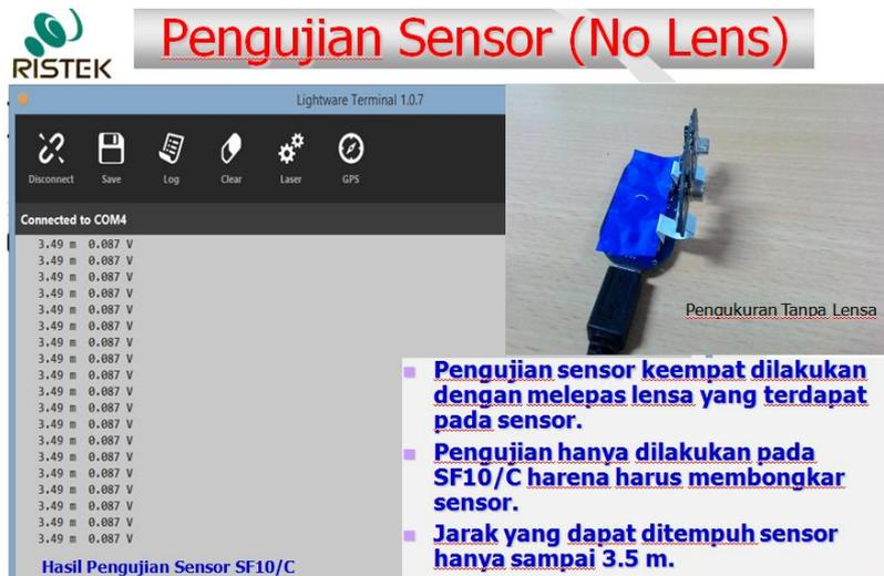
■ **Gambar 17.** Hasil Pengujian SF10/C dan SF30/C (tanpa lensa)
