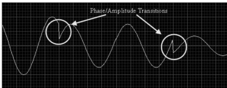
■ Gambar 9. Transisi Sinyal Termodulasi Tanpa Filter
