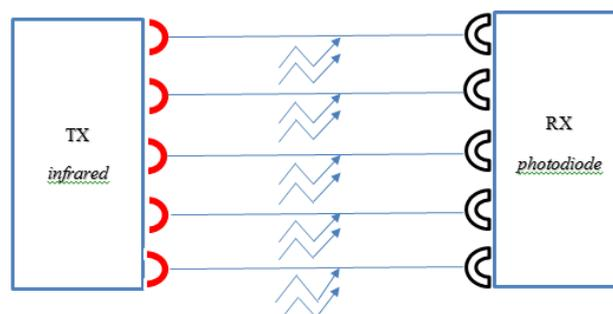
■ Gambar 6. Sensor *Photodiode* Berkerja pada Tempat Sampah
