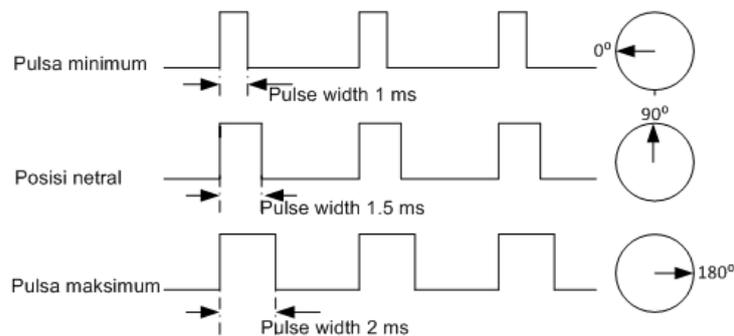
■ Gambar 12. Prinsip Kerja Motor Servo
