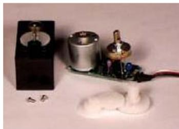
■ Gambar 9. Sistem Mekanik Motor Servo [6]
