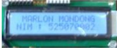
■ **Gambar 16.** Tampilan Hasil Pengujian Modul *Display LCD*
