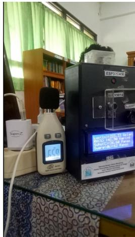
■ **Gambar 13.** Pengujian suara pada jarak 3 meter
