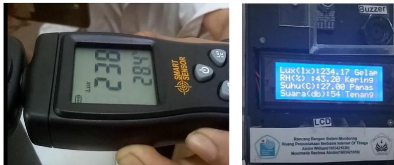
■ **Gambar 11.** Pengujian lux saat lampu dinyalakan
