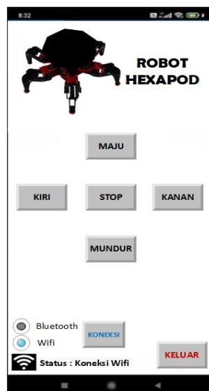
■ Gambar 12. Tampilan aplikasi kendali gerakan robot pada smartphone
