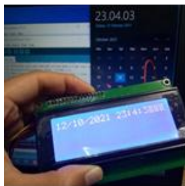
■ Gambar 5. Pengujian RTC DS3231 dengan Waktu yang ditunjukkan pada Laptop
