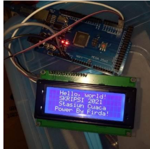
■ Gambar 4. Pengujian LCD 20×4
