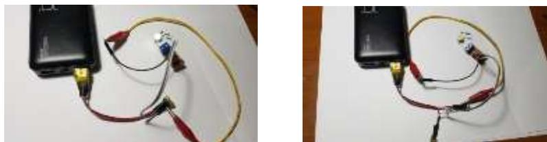
■ **Gambar 22.** Pengujian Rangkaian Transistor Switching dengan Data “*Low*” dan “*High*”
