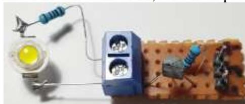
■ **Gambar 21.** Rangkaian Transistor Switching dengan Beban Lampu DC
