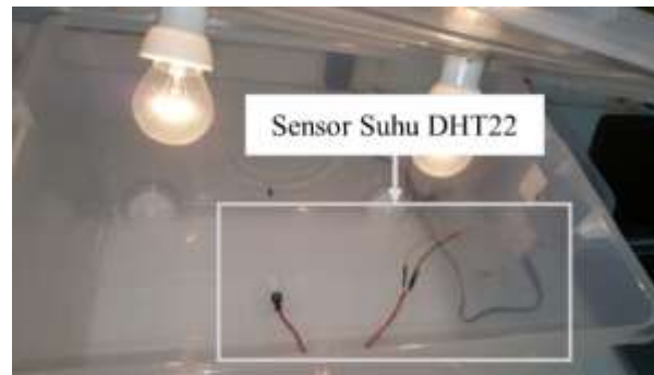
■ Gambar 5. Realisasi modul pendeteksi suhu dengan sensor suhu DHT22
