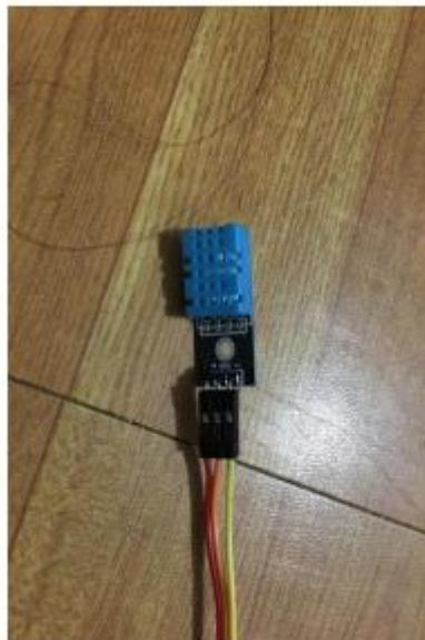
**Gambar 4.** Sensor DHT11
