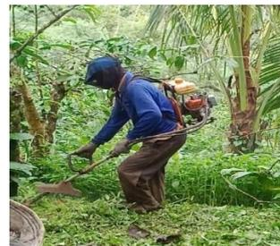
Gambar 2. Memotong Rumput Menggunakan Mesin Gendong
