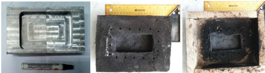
Gambar 3. Cetakan logam, pasir resin furan, dan pasir komossa
