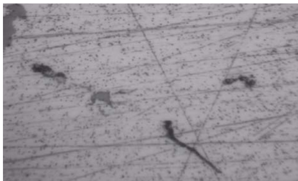
Gambar 15. Hasil pengamatan struktur mikro spesimen cetakan pasir resin furan
