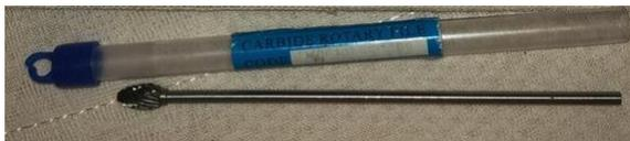
Gambar 4. Carbide Rotary File Tool yang Digunakan untuk Memperbesar Diameter
