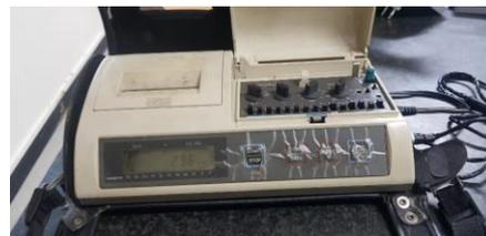
Gambar 2. Alat Ukur Kekasaran Permukaan Mitutoyo Surfest SJ-301 dengan Kecermatan 0,02  $\mu\text{m}$
