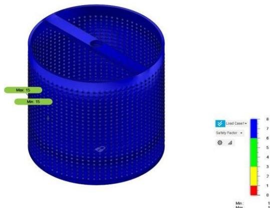
Gambar 10. Analisis *Safety Factor* pada Tabung Berlubang Alat Peniris Minyak
