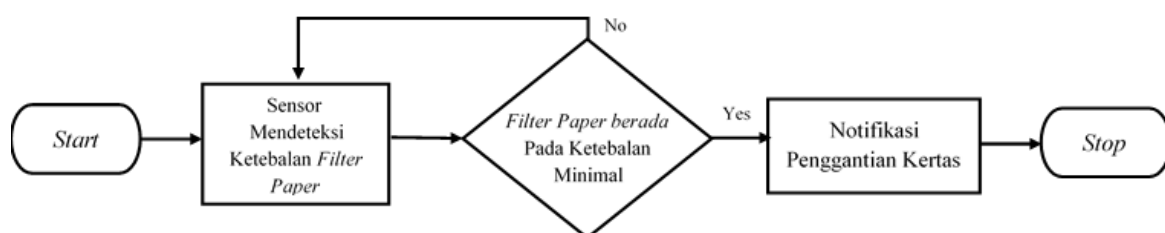
Gambar 10. Flow chart kerja limit switch pada mesin coolant filtration
