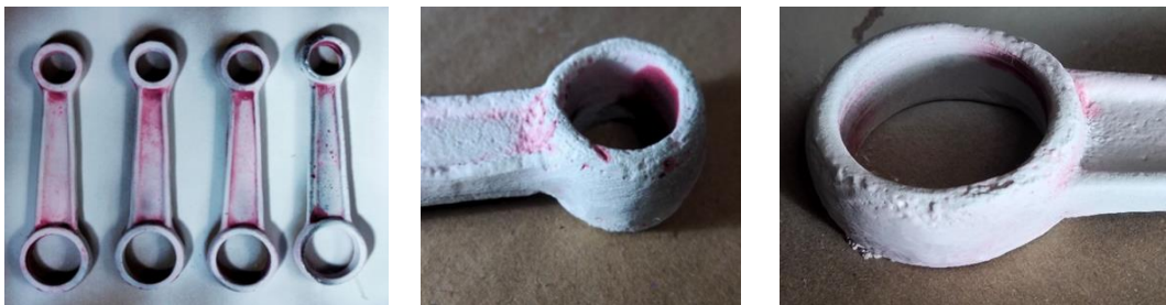
Gambar 7. Hasil Pengujian Dye Penetrant Paska Uji Lelah
