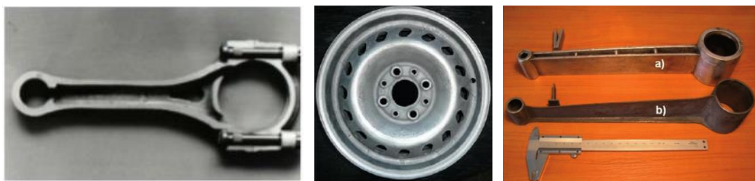
Gambar 2. Komponen TWDI dan/atau TWADI [1], [9], [10]
