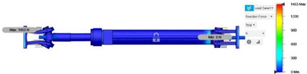
Gambar 16. Simulasi *reaction force* silinder hidrolik
