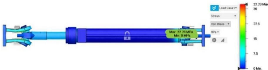
Gambar 14. Simulasi *stress* silinder hidrolik
