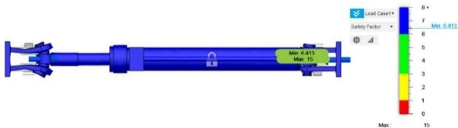
Gambar 13. Simulasi *safety factor* silinder hidrolik.
