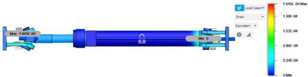
Gambar 17. Simulasi *strain* silinder hidrolik
