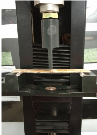
Gambar 6. Penempatan spesimen uji lentur
