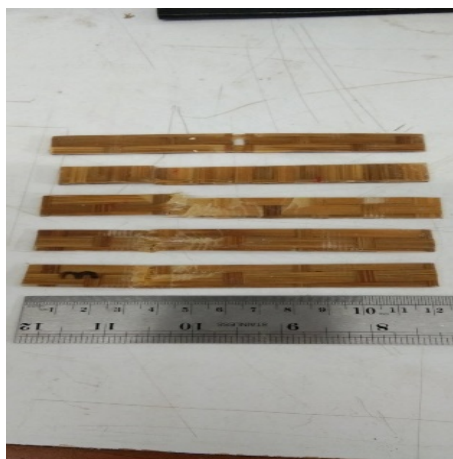
Gambar 7. Hasil pengujian tensile spesimen standar pengujian ASTM D3039/D3039M
