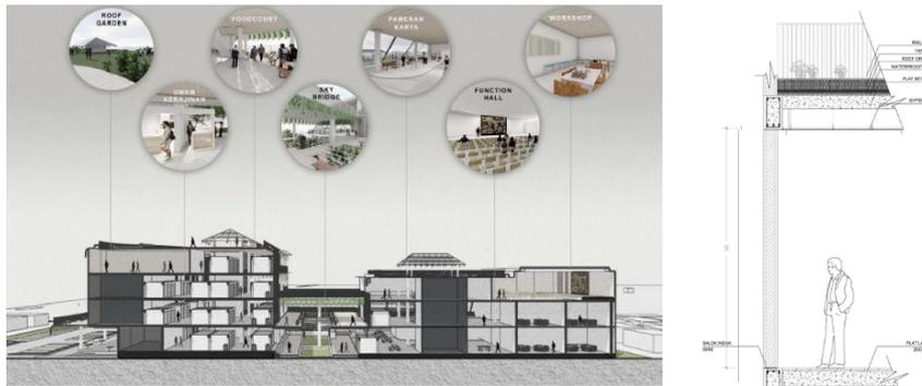
Gambar 15. Potongan Perspektif dan Detail Roof Garden
