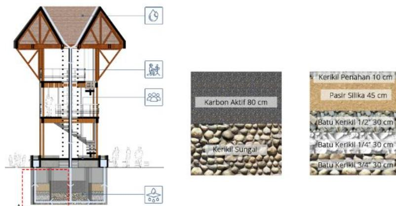
Gambar 11. Pos Penyediaan Air Bersih dan Filtrasi Air
