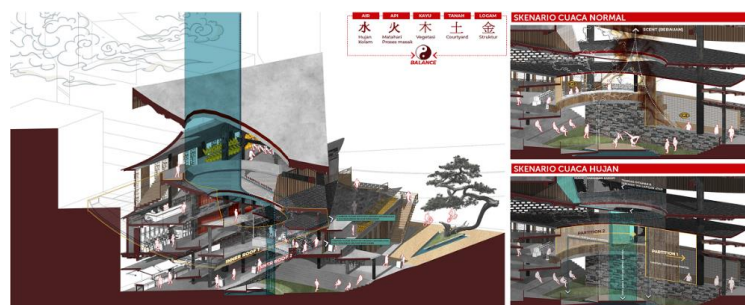
Gambar 14. Potongan aksonometri & diagram respon bangunan terhadap hujan
