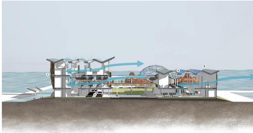
Gambar 22. Skema sirkulasi udara pada bangunan
