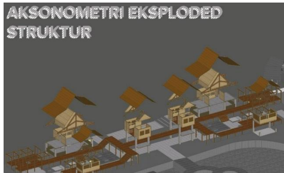
Gambar 11. Ilustrasi Struktur Utama dan Atap – Struktur Pondasi Bangunan di Pesisir Sumber: Pribadi, 2021
