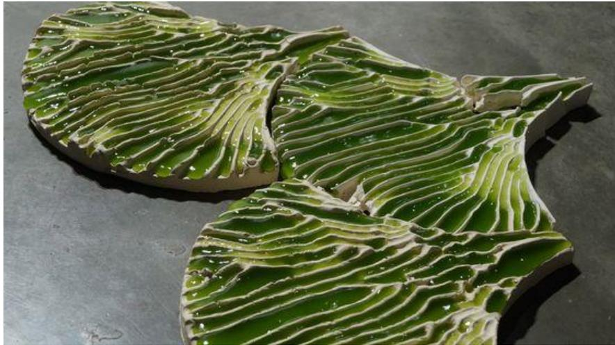
Gambar 3. Indus, Material ubin yang dapat menyaring udara
