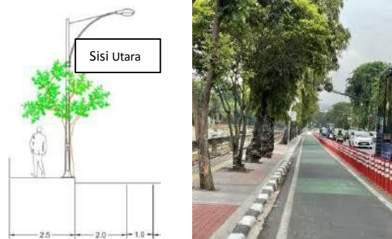
Gambar 18. Potongan dan Foto Jalur Pejalan Kaki Setelah Stasiun Juanda Sisi Utara Sumber : Dokumentasi Penulis, 2023
