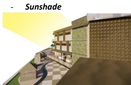
Gambar 23. Sinar Matahari dari Barat Sisi barat bangunan mendapat sinar matahari yang maksimal. Meskipun mendapat sinar matahari yang lebih dari cukup namun hal ini akan menyebabkan peningkatan suhu dalam ruangan.
