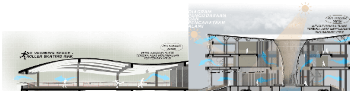
Gambar 16. Diagram Pengudaraan dan Pencahayaan Alami Sumber: Penulis, 2022
