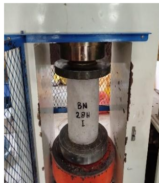
Gambar 6. Pengujian kuat tekan beton 28 hari
