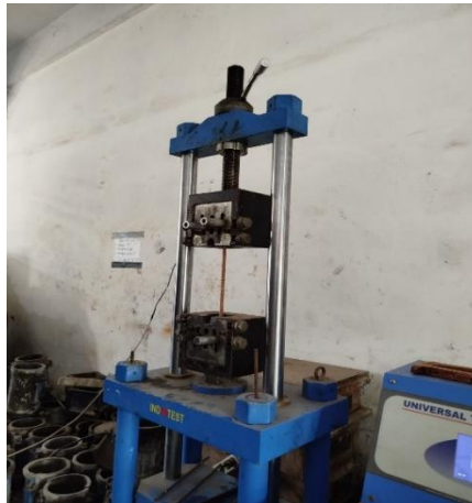
Gambar 7. Pengujian tarik tulangan
