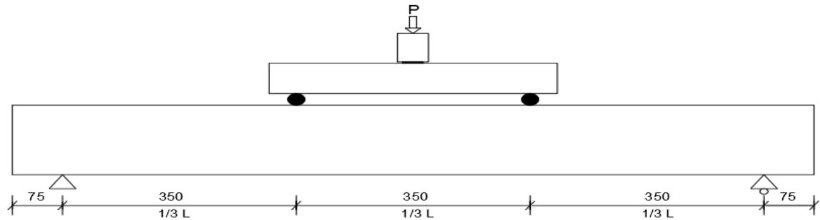
Gambar 5. Skema pembebanan lentur
