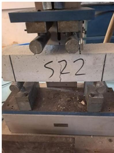
Gambar 6. Hasil uji coba lentur beton berserat
