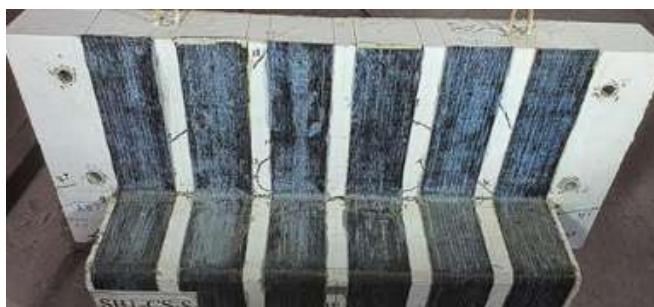
Gambar 3. Pengaplikasian lembaran CFRP pada balok spandrel berbentuk L (Ayaad & Oukaili, 2023)
