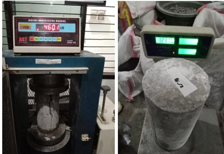
Gambar 2. Pengujian uji tekan
