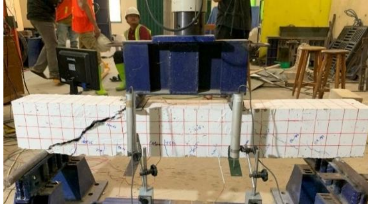
Gambar 8. Kondisi balok BRS setelah pengujian
