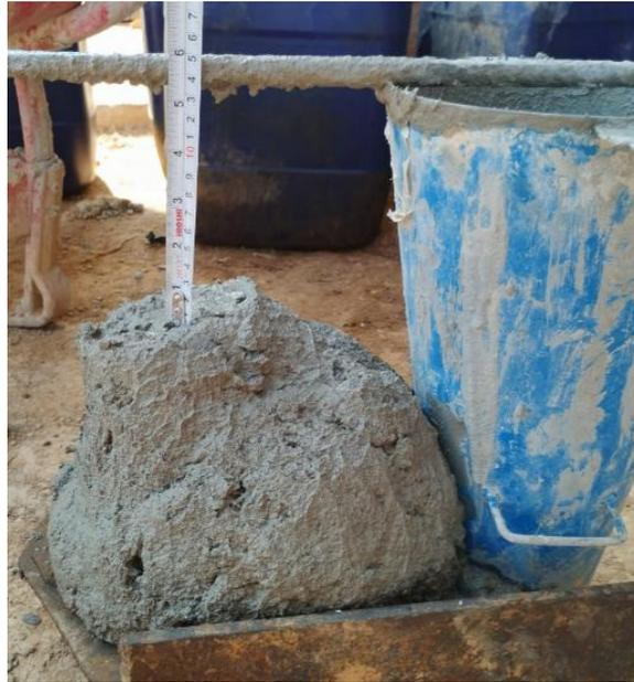
Gambar 6. Hasil slump test agregat terkontaminasi
