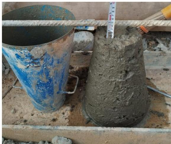
Gambar 5. Hasil *slump test* agregat diberi perlakuan khusus
