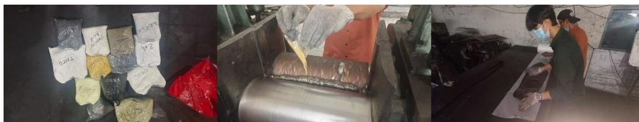
Gambar 1. Proses penggilingan bahan pembentuk karet
