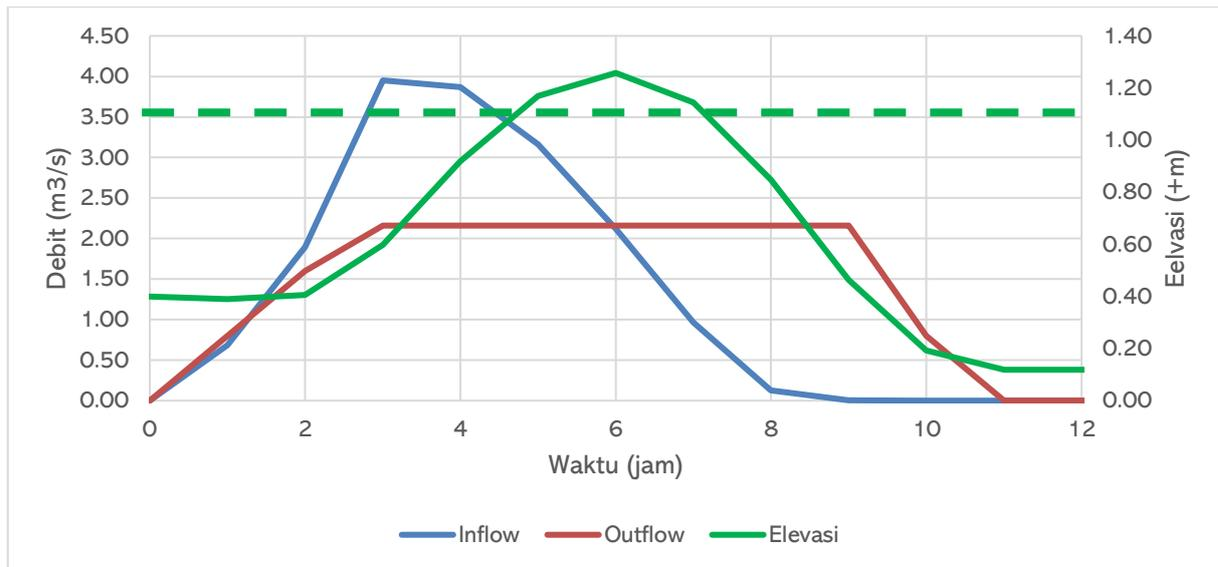
Gambar 6. Fluktuasi muka air dan pompa untuk pola operasi eksisting
