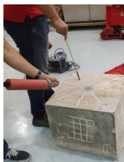
Gambar 5. Proses pembersihan lubang
