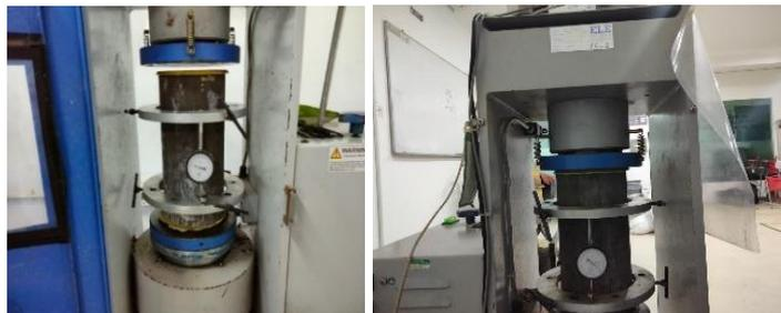
Gambar 2. Pengujian modulus elastisitas
