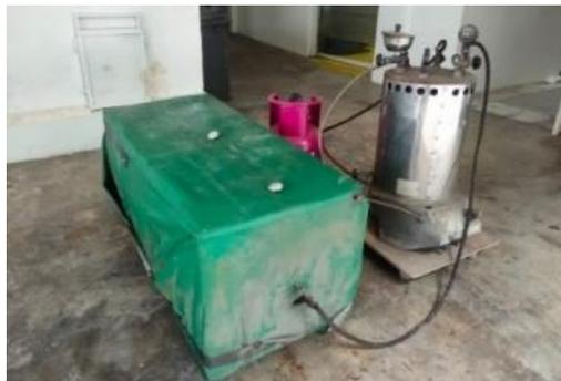
Gambar 1. Perawatan benda uji dengan metode penguapan
