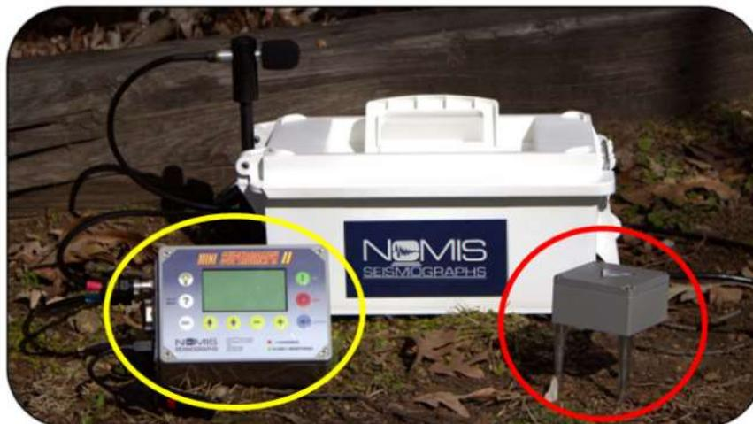
Gambar 2. Seismograf dari NOMIS tipe mini-supergraph
