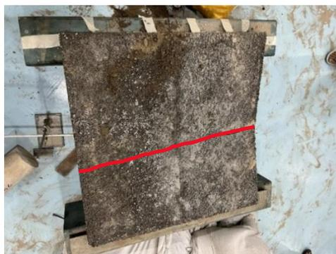
Gambar 6. Pola Kerusakan Pada Sambungan Dinding Panel *Styrofoam* 70%
