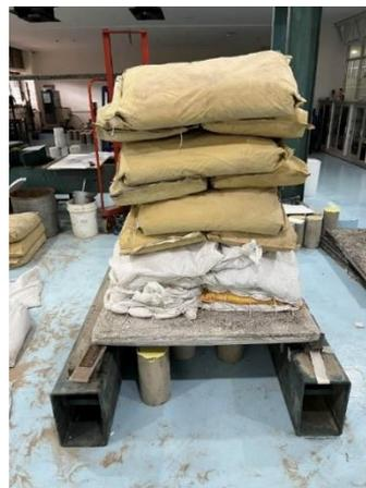
Gambar 2. Pengujian Sambungan Dinding Panel
