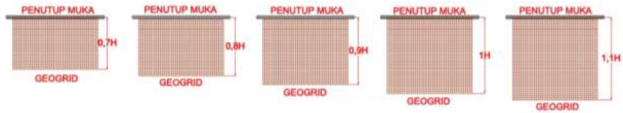
Gambar 11. Ilustrasi panjang penjangkaran dinding MSE tampak atas
